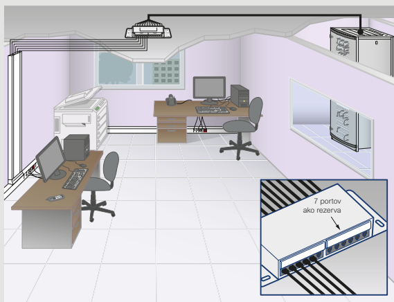
Konsolidačný bod použitý na vytvorenie flexibilnej zóny. 7 z 12 portov zostáva nevyužitých ako rezerva.
