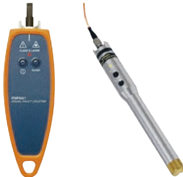
Príklad vizuálnych lokátorov chýb optickej kabeláže
