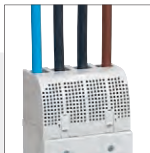
KRYTY SVOREK Zajišťují krytí IP 2X pro připojovací svorky
