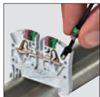
Automatické připojení pevného vodiče nebo ohebného vodiče s dutinkou zasunutím do svorek (pro svorky šířky 5 a 6 mm)
